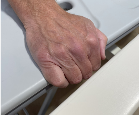
Der Spalt zwischen Seitengitter und Liegefläche .
